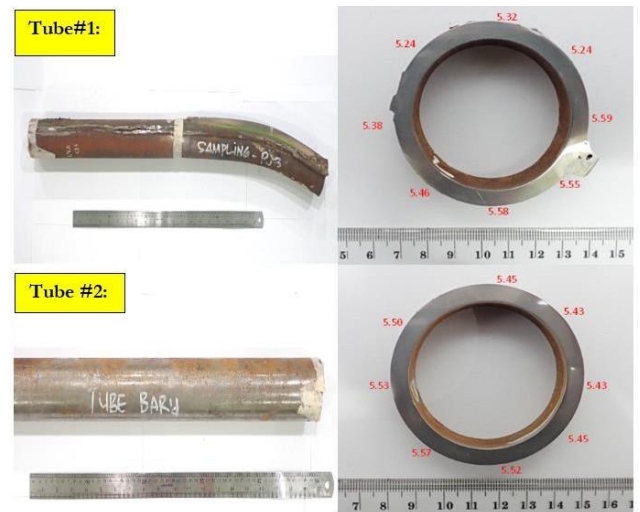
Gambar 2. Hasil pengukuran ketebalan dari potongan melintang tube #1 (yang mengalami deformasi/ lama) dan tube #2 (baru)
