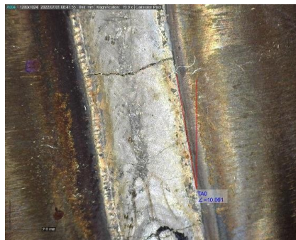
GAMBAR 11. Plot manik 150A DC ER1100 dengan kemiringan 10°
