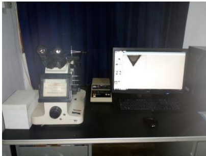
Gambar 10. Mikroskop optik untuk pengamatan dan pengambilan foto struktur mikro yang diamati
