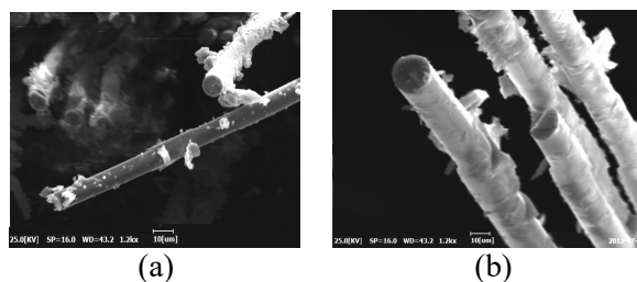
Gambar 13. Foto SEM pada patahan komposit epoksi dengan penambahan OG60 10% (a), 20% (b).
