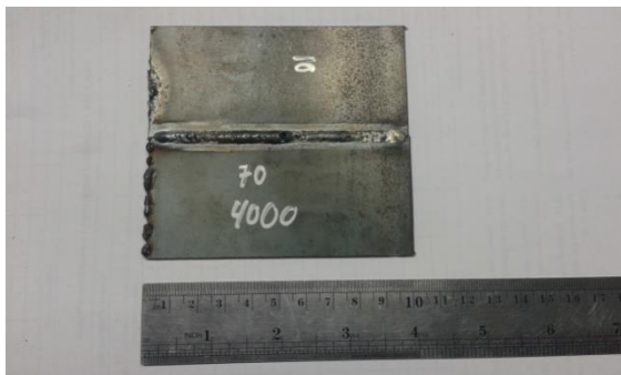
Gambar 2. Spesimen uji pada pengelasan TIG
