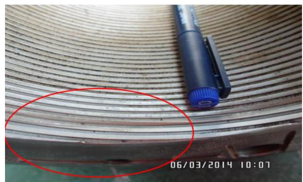
Gambar 7. Erosi pada pressure reducing bushing .
