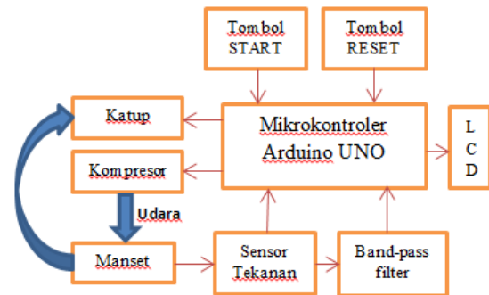
Gambar 2. Desain tensimeter digital
