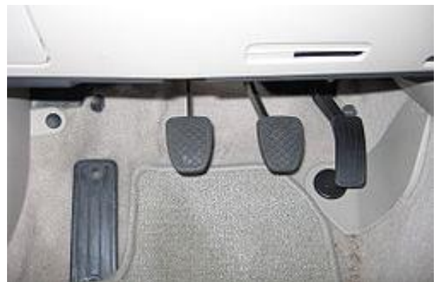
Gambar 1. Tuas kopling, rem dan gas
