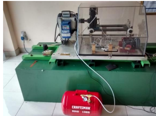
Gambar 2. Setup kompresor torak pada MFS
