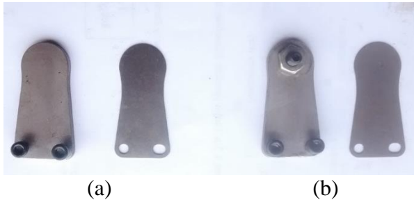
Gambar 4. Katup kompresor torak. (a) normal (b) kondisi rusak
