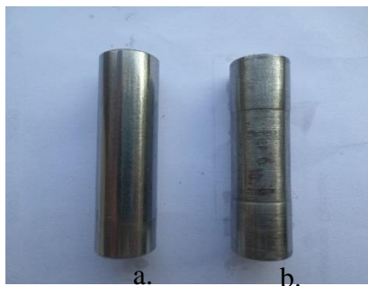
Gambar 5. Wrist pin: a. normal; b. Aus
