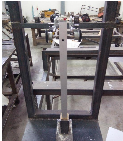
Gambar 2. Pengukuran pergeseran posisi dilakukan 50 cm diatas sambungan las
