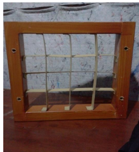
Gambar 2. Pengaturan susunan pengarah aliran udara berbentuk kotak (jarak sisi 3 cm dan sudut kemiringan 0°)
