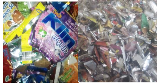
Gambar 1. Bahan dasar berupa limbah kemasan plastik aluminium foil (kiri) yang kemudian dicacah menjadi bentuk serpihan (kanan).
