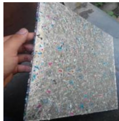
Gambar 2. Spesimen hasil hot press cacahan limbah kemasan aluminium foil.
