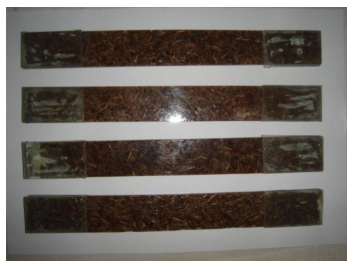
Gambar 4. Spesimen uji tarik menggunakan NaOH
