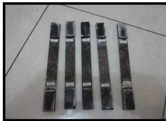
Gambar 3. Spesimen uji tarik menggunakan KMnO_4
