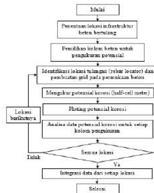
Gambar 3. Diagram alir langkah-langkah pengukuran potensial korosi
