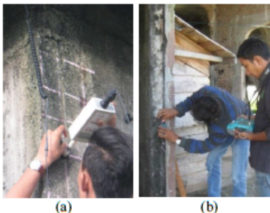
Gambar 8. (a). Pemetaan posisi baja tulangan, (b) Pengukuran potensial permukaan kolom
