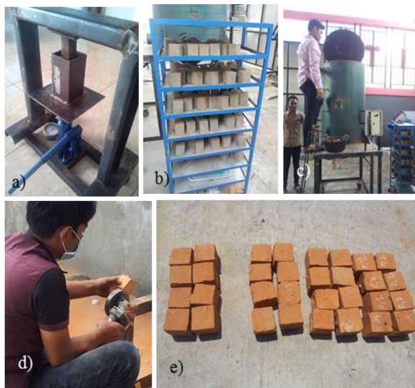
Gambar 1. Proses pembuatan sampel uji, a) Pencetakan, b) Pengeringan, c) Pembakaran, d) Pembentukan, e) Sampel uji
