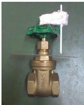
Gambar 4. Gate valve (D \frac{3}{4} inci atau 0.01905 m sesuai dengan saluran manifold )
