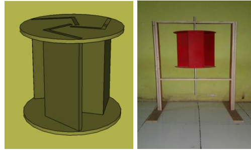
Gambar 2.3. Kincir Angin sumbu vertical tipe sudu 90^\circ 3 sudu
