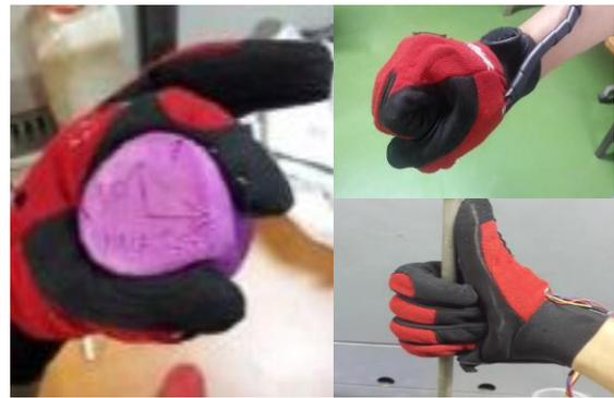
**Gambar 6 Kalibrasi *Motion Glove*, dari kiri ke bawah, *Half-Open*, *Closed* dan *Thumbs-Up***
