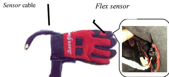
**Gambar 3** Purwarupa *Motion Glove* dan kantung *flex sensor* di dalam *glove*
