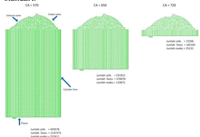
Gbr. 2 Geometri ruang bakar sistem dynamic mesh dengan metode layering
