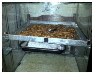
Gambar 3.b) Pengeringan dengan termokimia ( \text{CaCl}_2 ) pada malam hari
