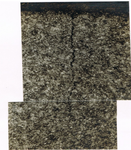
Gambar 11 Retakan yang disebabkan hidrogen pada rapat arus pemasukan hidrogen 100 mA/cm 2 , waktu 180 menit
