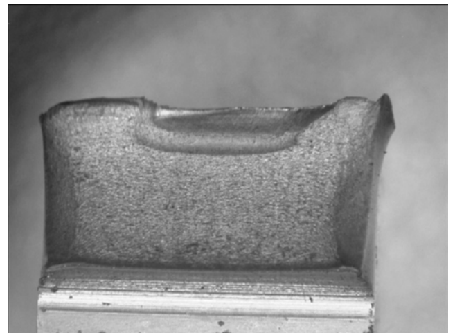
Gambar 11. Fraktograpi material AISI 4140 setelah proses temper holding time 60 menit
