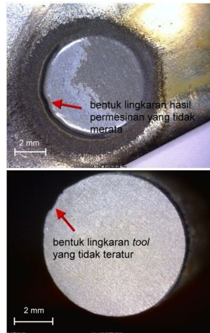
Gambar 5. Bentuk lingkaran benda kerja hasil permesinan yang dipengaruhi bentuk tool .
