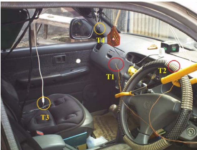
Gambar 10. Posisi Termokopel Pada Kabin Mobil
