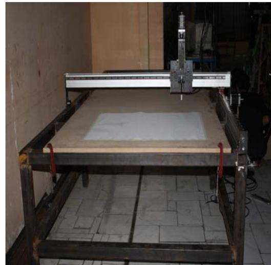
**Gambar 13. Prototipe Mesin CNC Batik**
