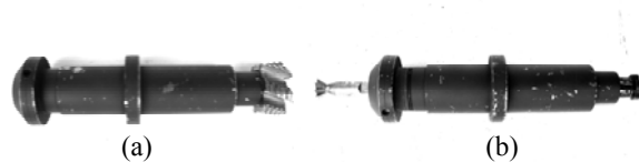
Gambar 5. Poros pemegang pahat (a) Jenis pahat perataan, (b) Pahat end mill
