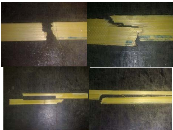
Gambar 14. Terjadi patahan secara acak pada daerah dekat penjepit
