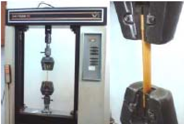
Gambar 10. Mesin Uji Tarik
