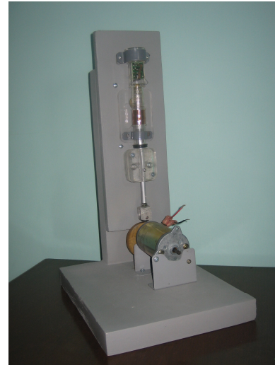
Gambar 5. Foto mekanisme VEH metode electromagnetic
