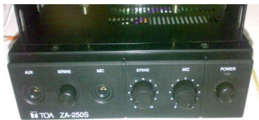
Gambar 3.5 Penguat sinyal suara TOA type ZA 250S dengan output power 25 watt
