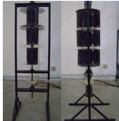
Gambar 5. Model turbin angin poros vertikal dengan rotor savonius U, a) tampak depan, b) tampak samping
