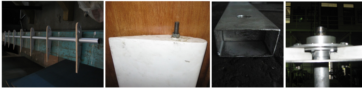
Gambar 5 Pembuatan turbin angin: (a) Rangka sudu, (b) Sudu jadi, (c) Lengan dan (d) Poros.
