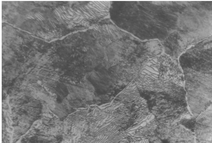
Gambar 2 Struktur mikro baja hipereutektoid hasil full anneal . Etsa: nital. Perbesaran 1000X
